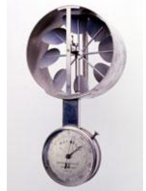
I Wright usarono questo, anemometro a mano per misurare la velocità del vento
